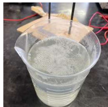
図2 飽和食塩水の電気分解の様子 図3 飽和食塩水の実験後の様子
