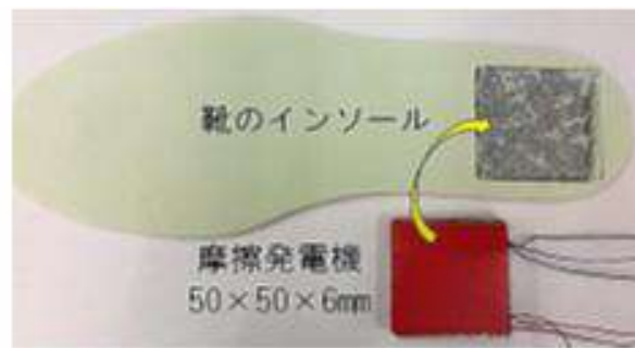
図2 インソール組込み摩擦発電機
