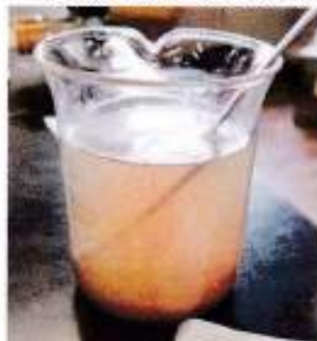
図17 沈殿が生じた液体に塩化第二鉄を添加した様子 (再掲)
