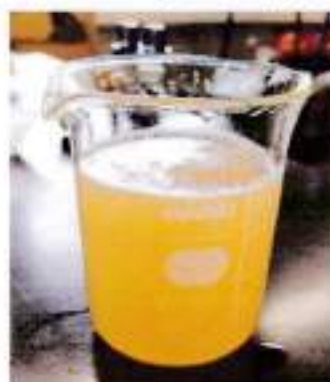
図10 リン酸二カリウム水溶液をろ液に加えた様子 (再掲)
