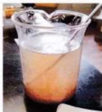
図11 沈殿が生じた液体に塩化第二鉄を添加した様子 (再掲)
