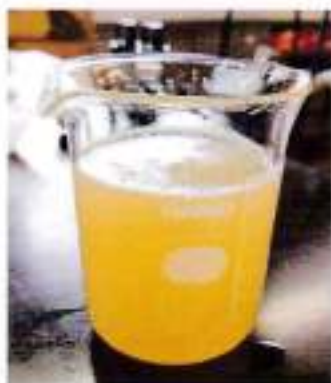
図4 リン酸二カリウム水溶液をろ液に加えた様子
