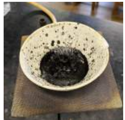
図14 NaOH反応後の黒い固体(実験1)
