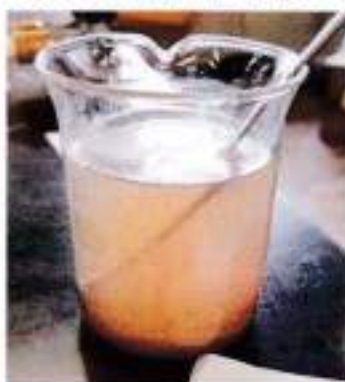
図5 沈殿が生じた液体に塩化第二鉄を添加した様子
