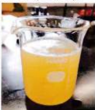
図16 リン酸二カリウム水溶液をろ液に加えた様子 (再掲)
