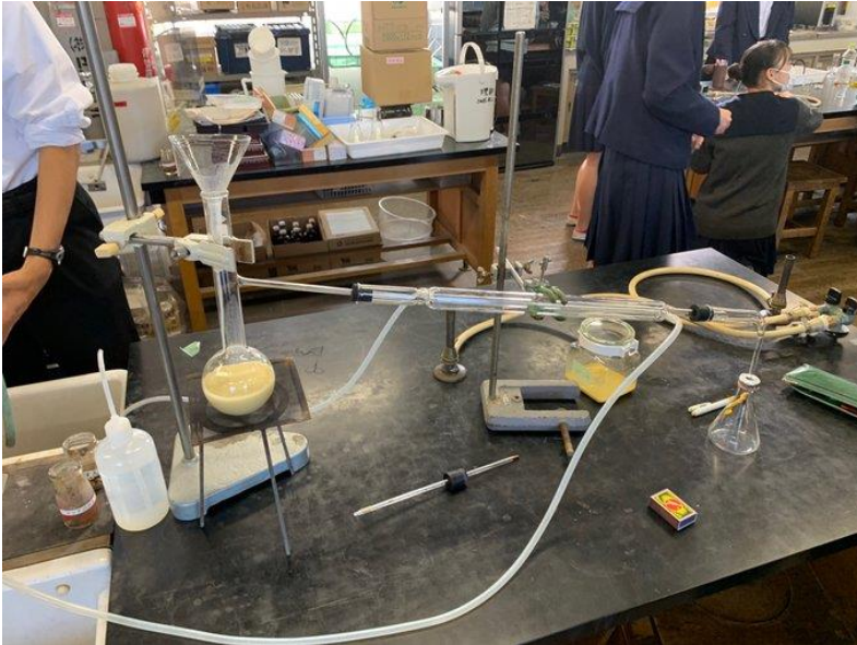
(図1リービッヒ冷却器での蒸留の様子)
