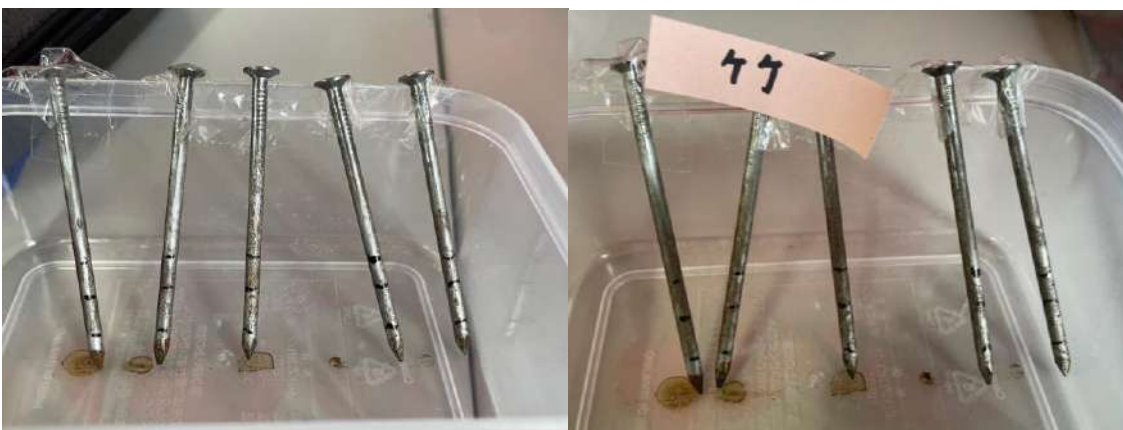
図1, 2 何もしなかった鉄釘(左)と竹抽出液を塗布した鉄釘(右) 11/28
