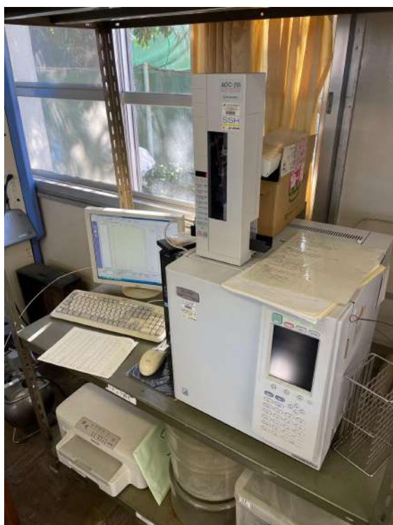
図10 本校にあるガスクロマトグラフィー
