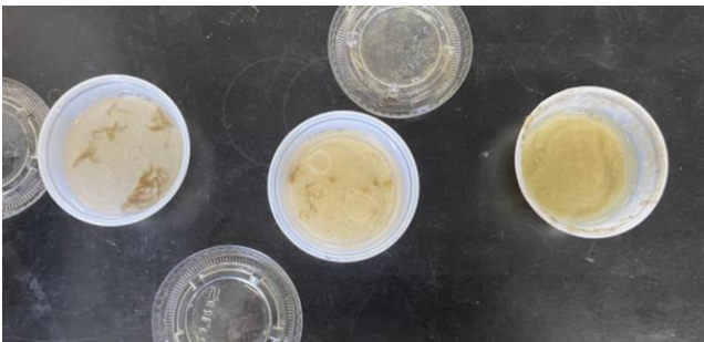
図3 自作コンディショナーの画像(どれもpH4.5でレシチン濃度が左から0.73 %, 2.19 %, 6.57 %)
