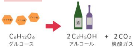
図1 アルコール発酵の化学反応式
