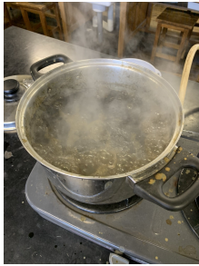
図1 \text{Na}_2\text{CO}_3 水溶液 で煮ている
