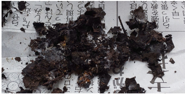
図1 腐葉土の中で分解途中のカゼインプラスチック
