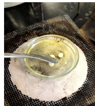
図5 蜜蝋を溶かしている様子
