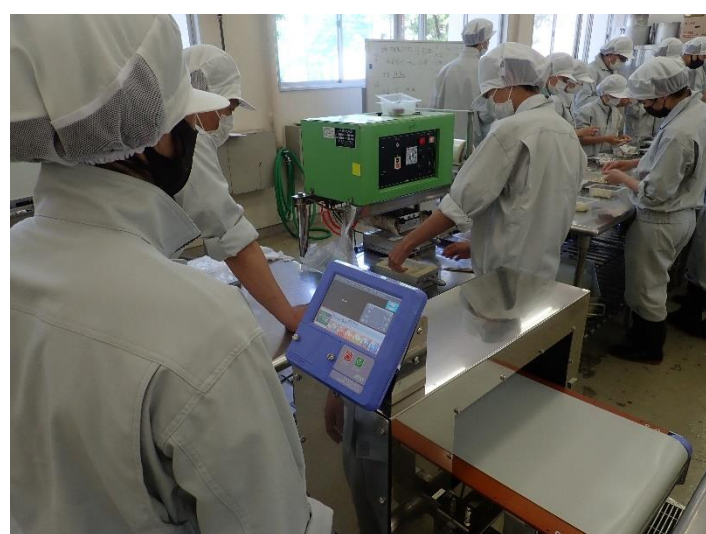
最後は金属探知機を通して検品します
