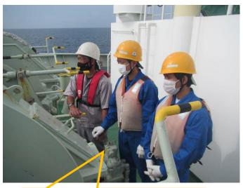
航海士の指示の下、乗組員ともに ロープを巻き取るスピードを調整す る位置を微調整する様子。
