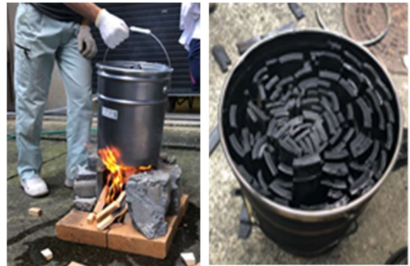
竹炭の精製実験装置 ペール缶の中の竹炭
