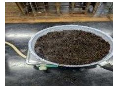
図1 土壌を加熱により滅菌をしている様子
