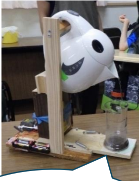
【作業(カフェ班)で活用】 スイッチを押すと… ポットが傾き、 お湯を注ぐ
